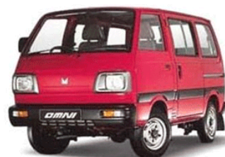
Fig. 3.1: Non aero dynamical shape of Maruti Omni.
